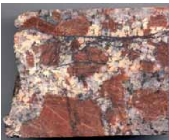
Photo 5 Exemple de granite altéré et fracturé. Forage GPK1 1380 m Example of altered, fractured granite. GPK1 borehole, 1380 m
