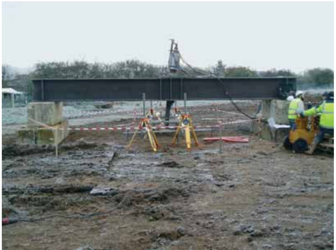
Dispositif expérimental d'essai d'arrachement Experimental pull-out test system
