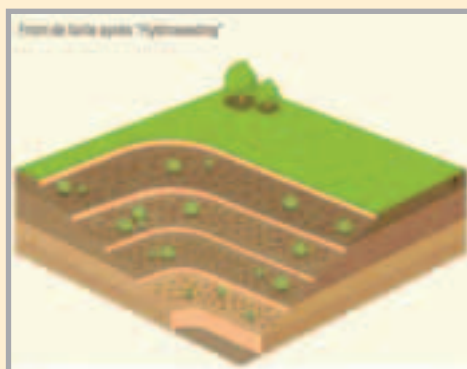
Figure 8 Front de taille après "hydroseeding" Quarry face after hydroseeding
