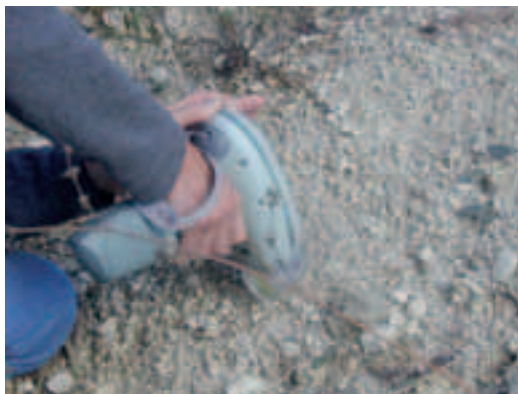
Photo 12 Mesure de la concentration en arsenic dans les sols
