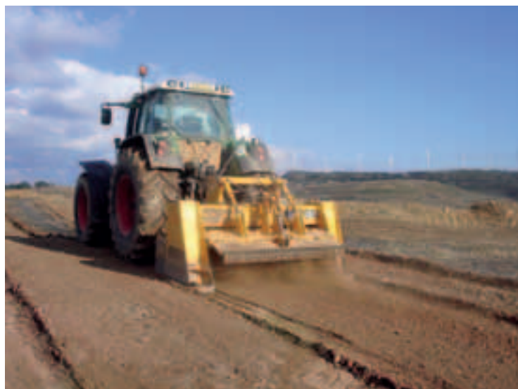
Photo 14 Mélange de la grenaille d'acier avec le sol par un casse-caillou Mixing of steel shot with the soil by a stone breaker
