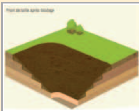
Figure 2 Front de taille après talutage Quarry face after sloping
