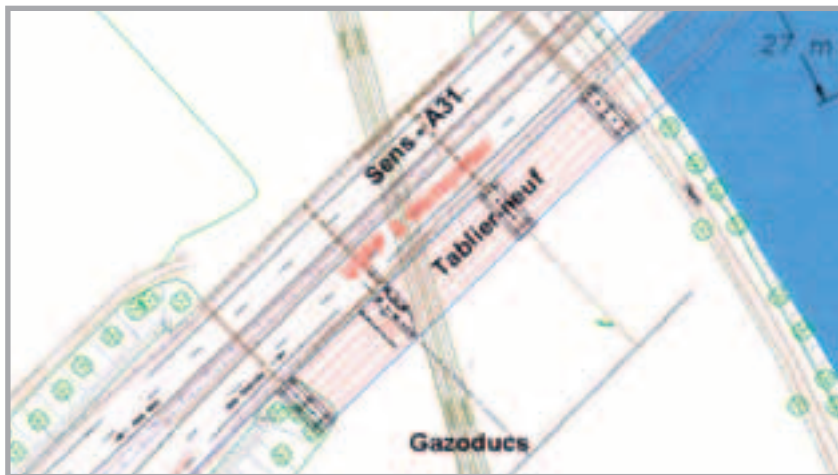
Figure 23 Schéma montrant comment le VIPP à démonter est coincé Drawing showing how the viaduct to be dismantled is stuck
