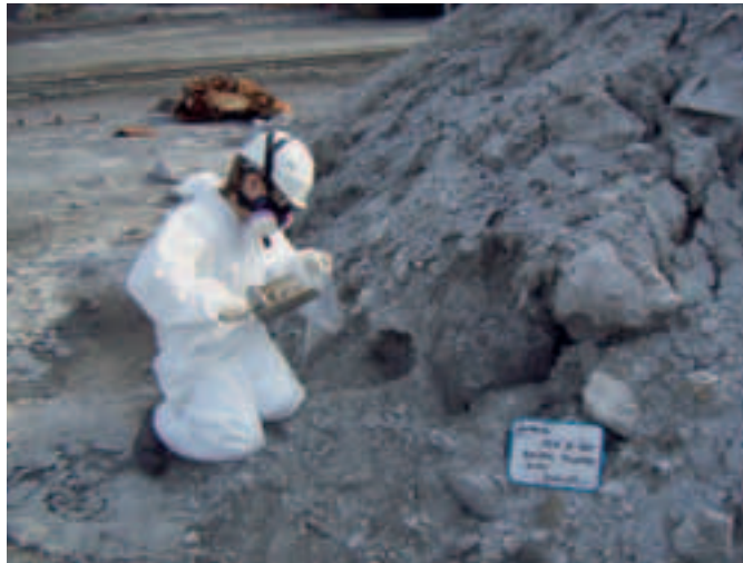
Photo 2 Echantillonnage des résidus sur site Sampling residues on site
