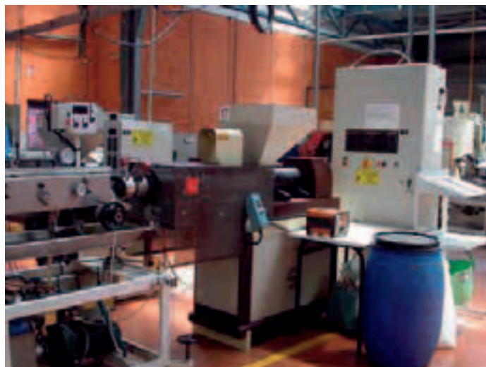
Photo 8 Les mélanges maîtres SBS/bitume obtenus par extrusion doublent les cadences
