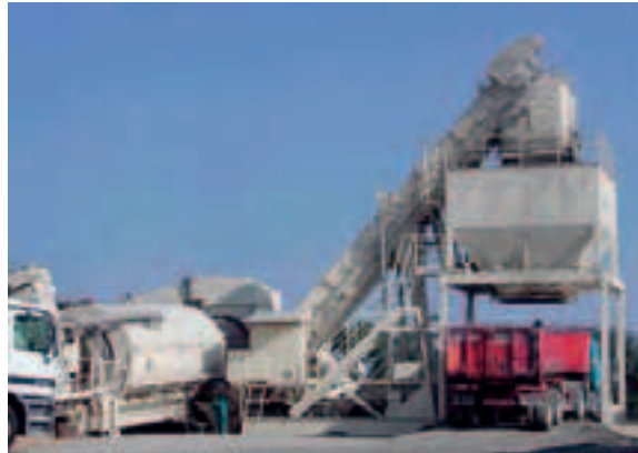
Photo 3 Des taux de recyclage élevés grâce à un poste à double tambour
