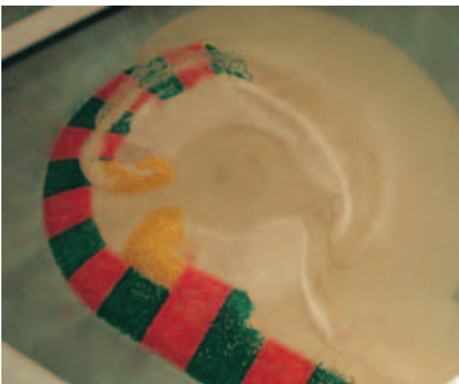
Photo 2 Déformation de la plage sud-est sur le modèle physique
