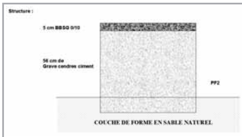
Figure 2 Principe de mise en œuvre Application technique
