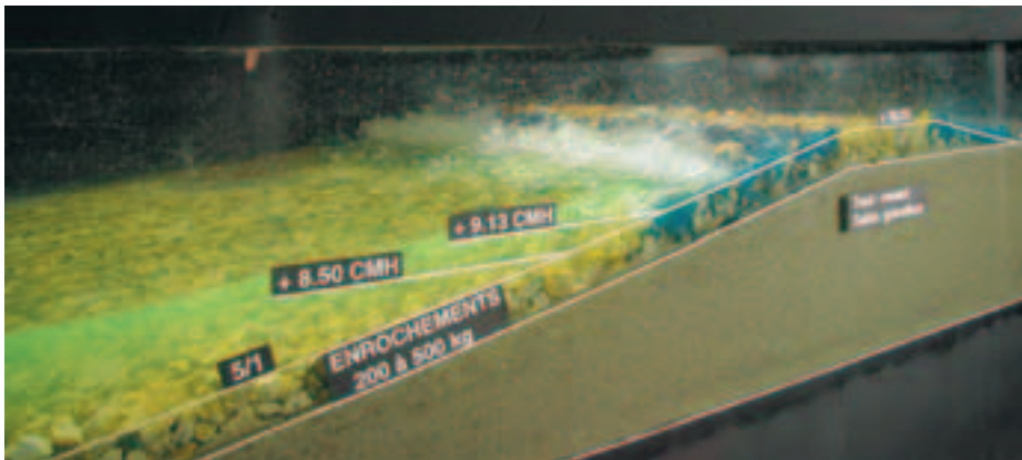
Figure 3 Schéma de l'aménagement à l'issue des essais sur modèles Development scheme following tests on models
