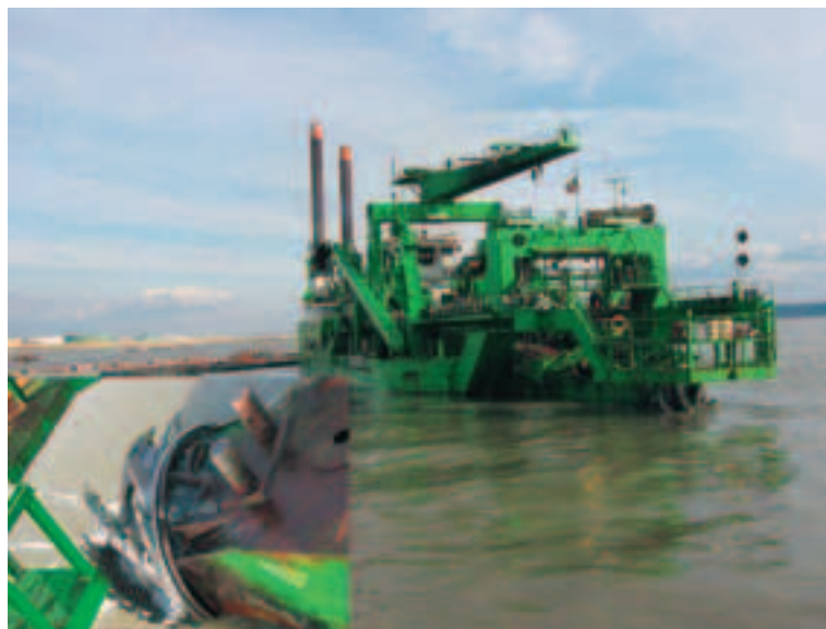
Photo 2 Drague aspiratrice stationnaire avec désagrégateur "Vlaanderen XIX" de la société Dredging International
