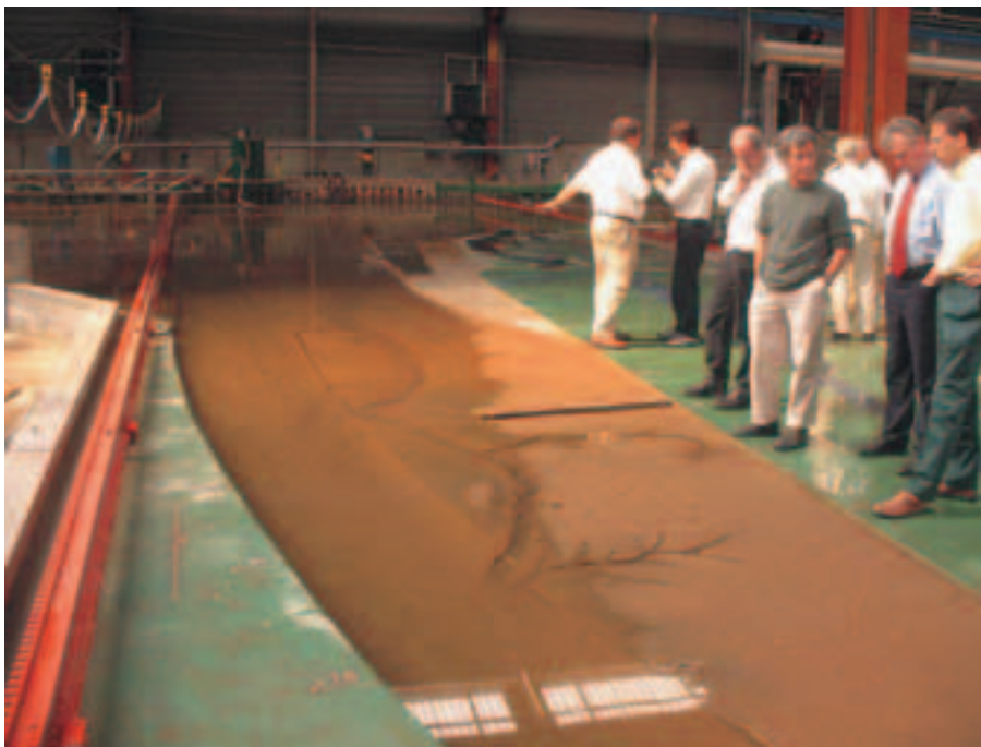
Photo 2 Le modèle réduit à fond mobile en cours de test du projet de restauration de la vase nord
