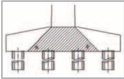
Figure 9 Modélisation des semelles souples des piles P4 et P5 Modelling the flexible foundation slabs of piers P4 and P5
