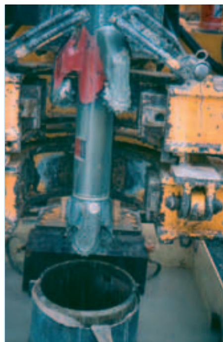
Photo 7 Outil spécial utilisé pour le forage en Ø 270 mm dans les marno-calcaires Special tool used for boring to dia. 270 mm in marly-calcareous rocks
