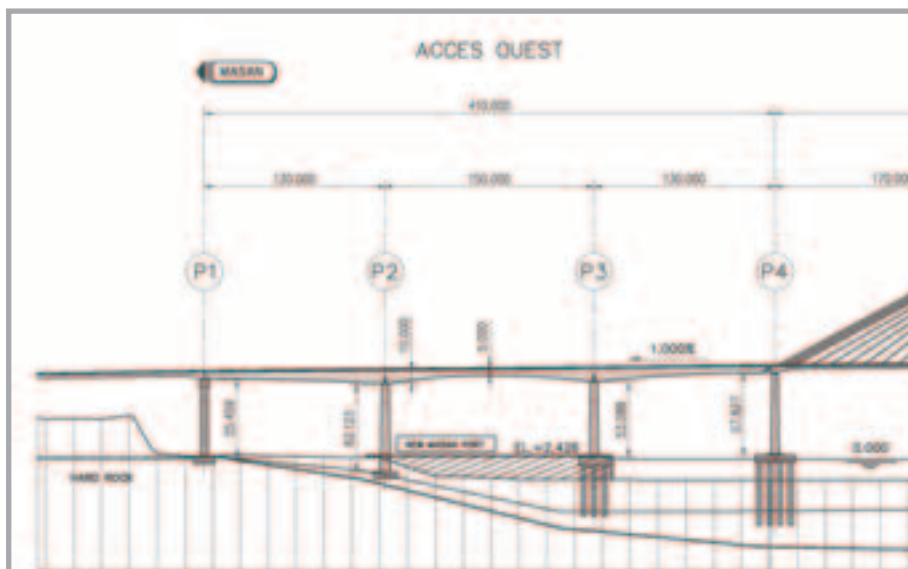
Figure 2 Elévation longitudinale de l'accès ouest Longitudinal elevation view of the western approach
