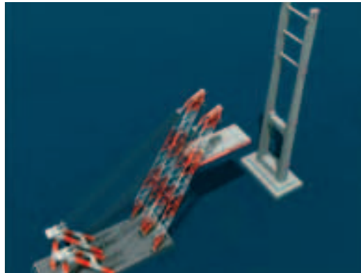
Photo 12 Vue virtuelle de la mise en place du premier tronçon de tablier haubané Virtual view of placing of the first section of cable-stayed deck
