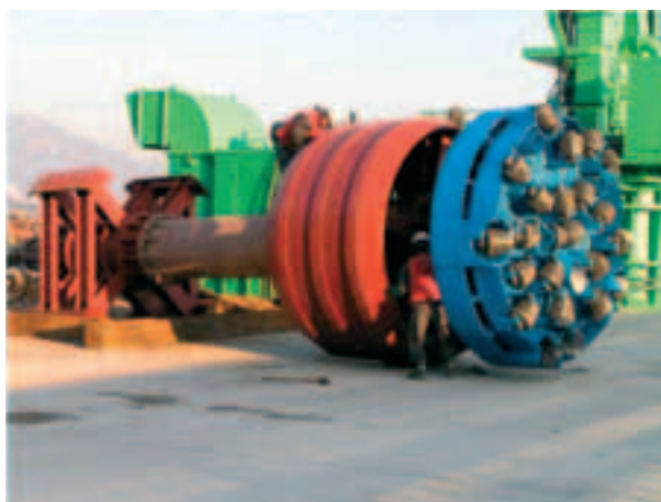
Photo 4 Outil de forage pour les pieux de diamètre 3 m Boring tool for piles of diameter 3 m
