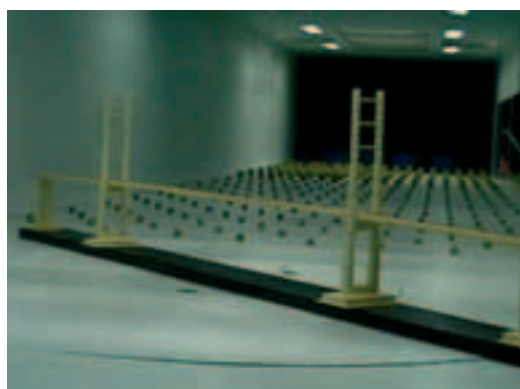
Photo 17 Essai au vent, maquette de l'ouvrage complet Wind test, model of the complete structure
