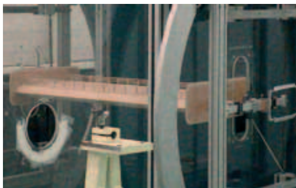
Photo 16 Essai au vent, maquette du pylône seul Wind test, model of the tower only
