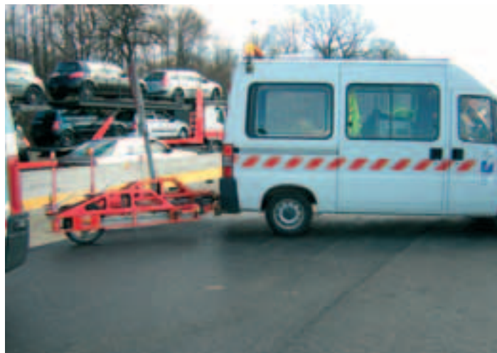
Photo 3 Contrôle A.P.L du LROP sur la couche de Modulovia A.P.L inspection by the LROP on the Modulovia layer
