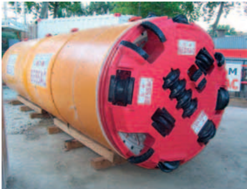
Photo 1 Microtunnelier à roue pour creusement dans la roche
