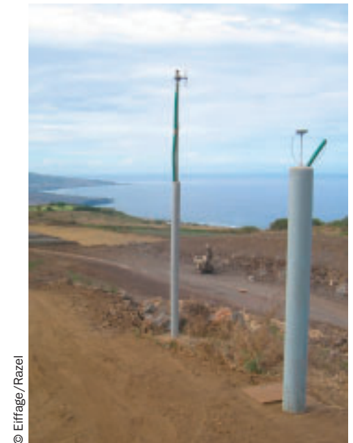
Photo 13 Station de référence fixe GPS (pivot) Fixed GPS reference station (pivot)
