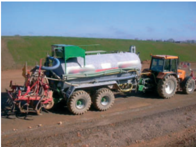
Photo 1 L'arroseuse-enfouisseuse Landfill sprinkler system
