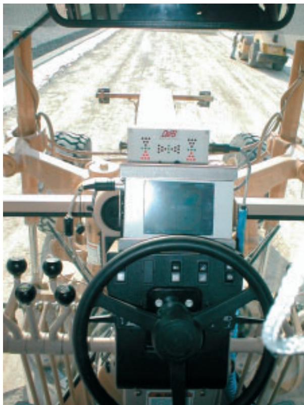
Photo 14 Vue d'une cabine de niveleuse équipée DPS
