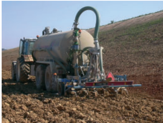
Photo 2 Arroseuse-enfouisseuse en cours d'injection
