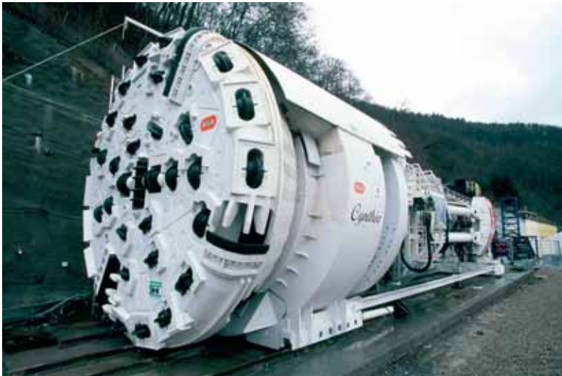
Tête de coupe du tunnelier "Cynthia" "Cynthia" TBM cutting head
