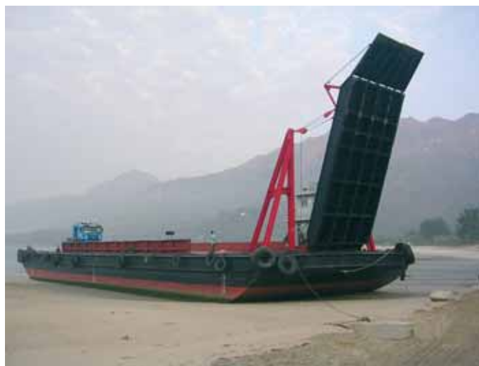
Photo 7 Barge de chargement du tunnelier proche du portail nord du tunnel de Chi Ma Wan
