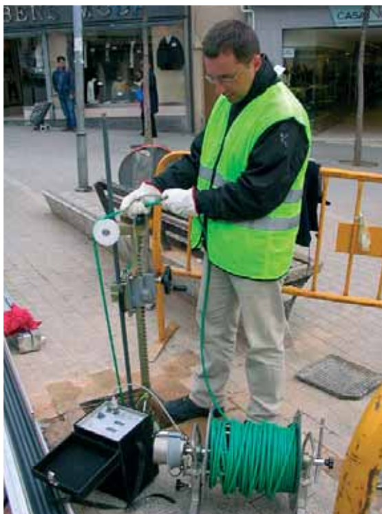
Photo 4 Mesure dans un extensomètre incrémental
