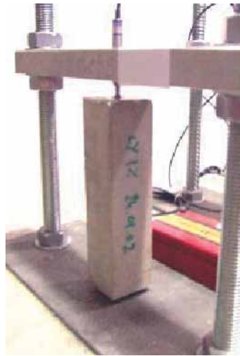
Photo 6 Dispositif de mesure du retrait après prise Device for measuring post-setting shrinkage
