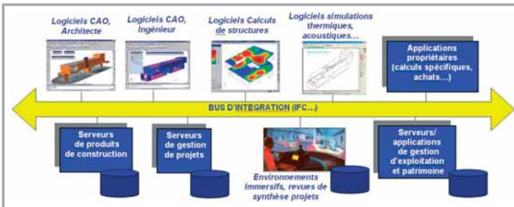
Figure 2 Solution interopérable autour d'un bus d'intégration qui favorise la collaboration entre acteurs de projet
