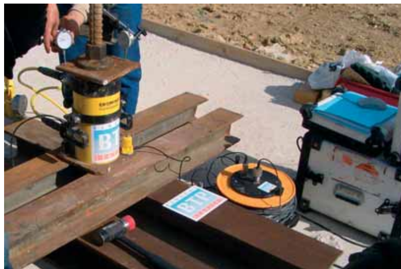
Photo 3 Tirant expérimental Eurosol Fondations. Dispositif d'essai
