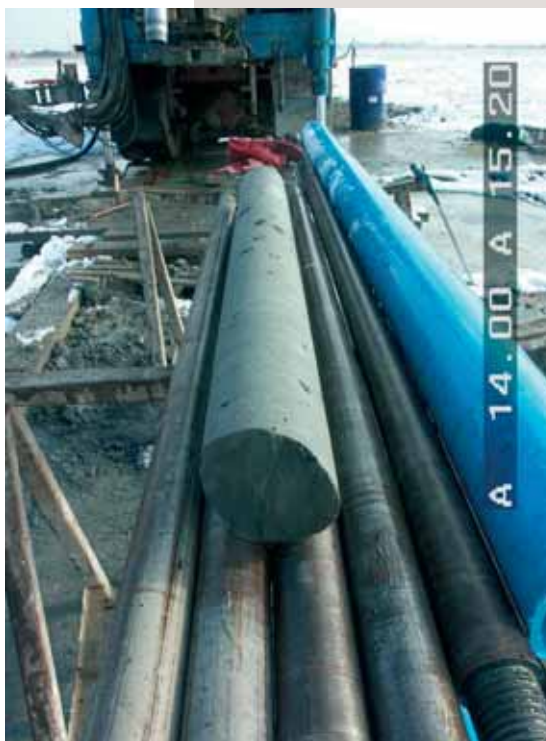
Photo 4 Carotte extraite entre 14 m et 15,20 m dans un panneau CSM
