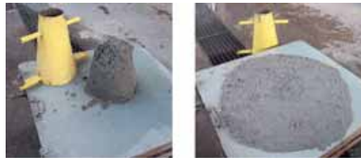
Photo 4 Différence de consistance entre un béton ordinaire ou vibré (à gauche) et un BAP (à droite)
