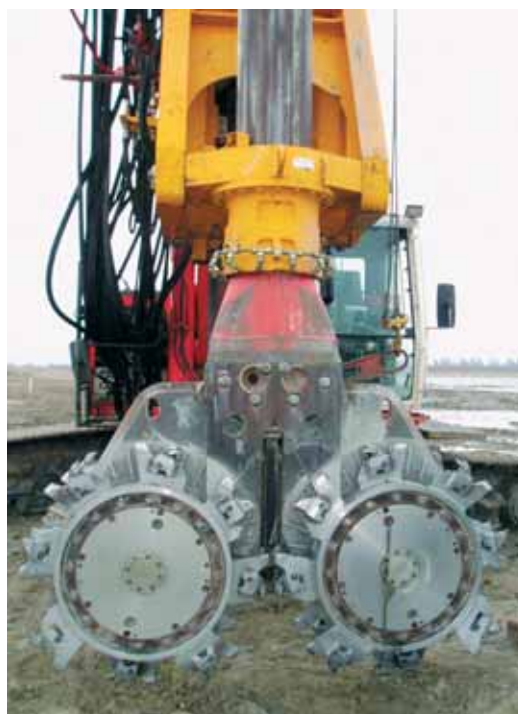
Photo 1 Le CSM Solétanche Bachy utilisé sur le chantier d'essai du Havre
