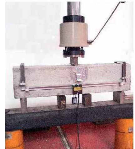
Photo 7 Essai de flexion trois points (détermination de la résistance à la fissuration) Three-point bending test (determination of cracking strength)
