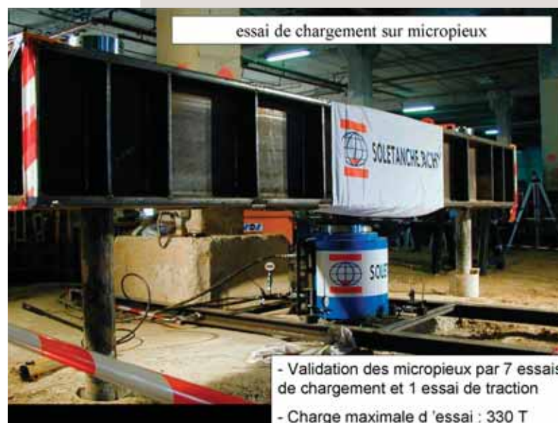
Photo 8 Essai de chargement de micropieu
