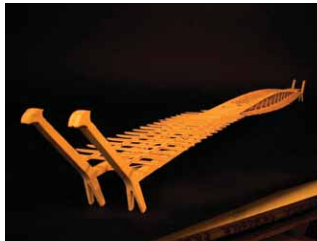
Figure 3 Schéma de la structure métallique montrant les "boomerangs" en bout
