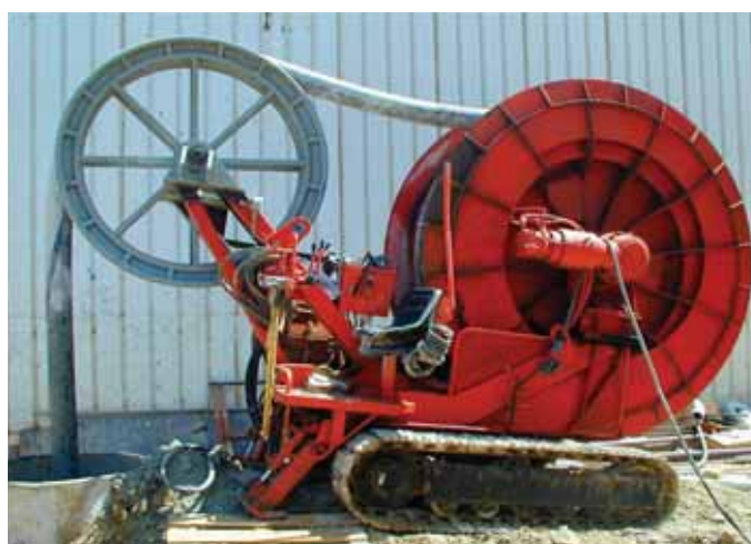
Photo 2 Bétonnage à l'"escargot"
