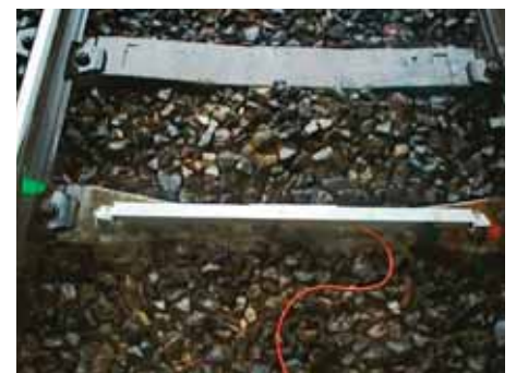
Vue rapprochée d'une électronivelles Close-up view of an electronic level gauge
