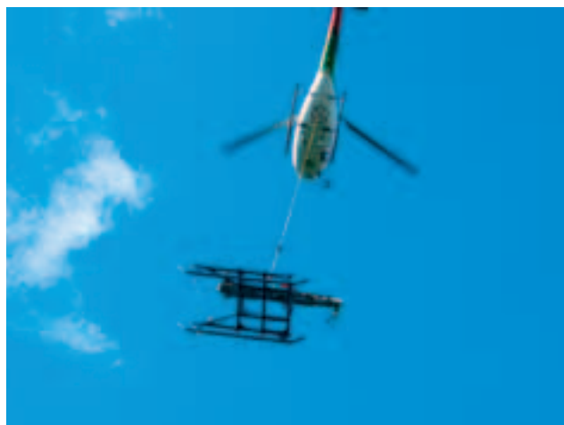
Photo 6 Héliportage de la foreuse hydraulique
