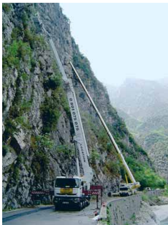
Photo 2 En avant plan, nacelle de 72 mètres, puis une grue automotrice 90 t In the foreground, 72-metre platform, then a 90-tonne self-propelled crane
