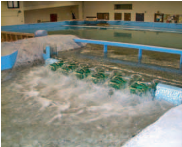
Photo 4 Simulation de crue avec des hausses fusibles Simulation of flood with fuse gates
