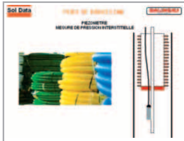
Figure 5 Piézomètre - Principe de fonctionnement Piezometer - Operating principle
