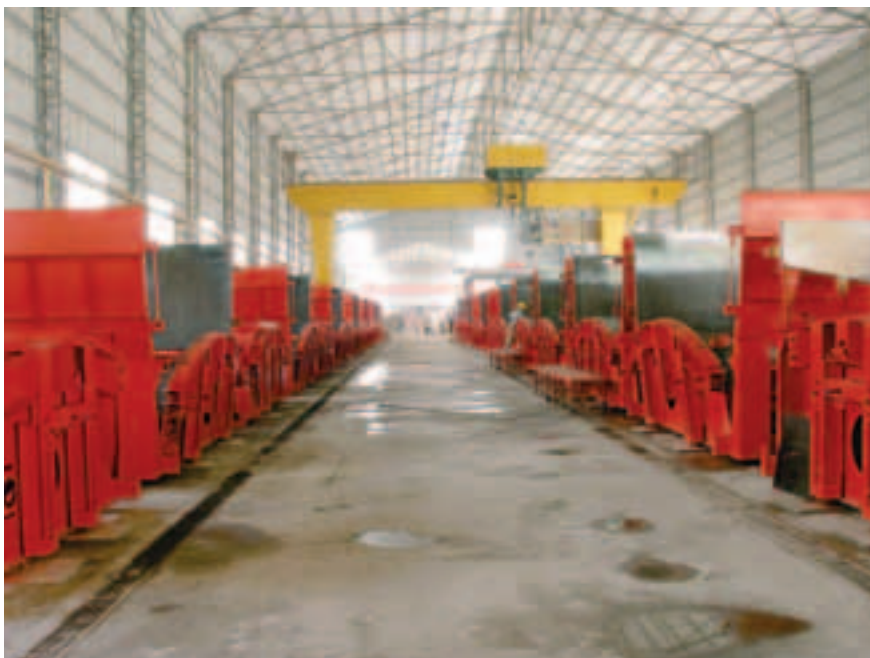
Photo 2 Usine de préfabrication des voussoirs de tunnel Tunnel segment prefabrication plant
