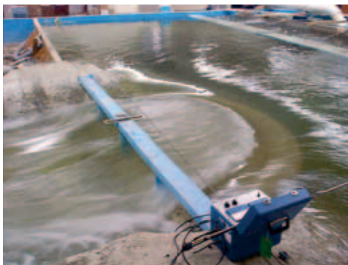
Photo 2 Enregistrement des vitesses d'écoulement sur le seuil courbe Recording flow velocities on the curved crest
