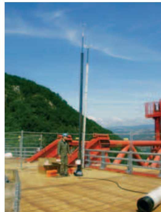
Anémomètre 3D et 2D (redondance), en cours de lancement
