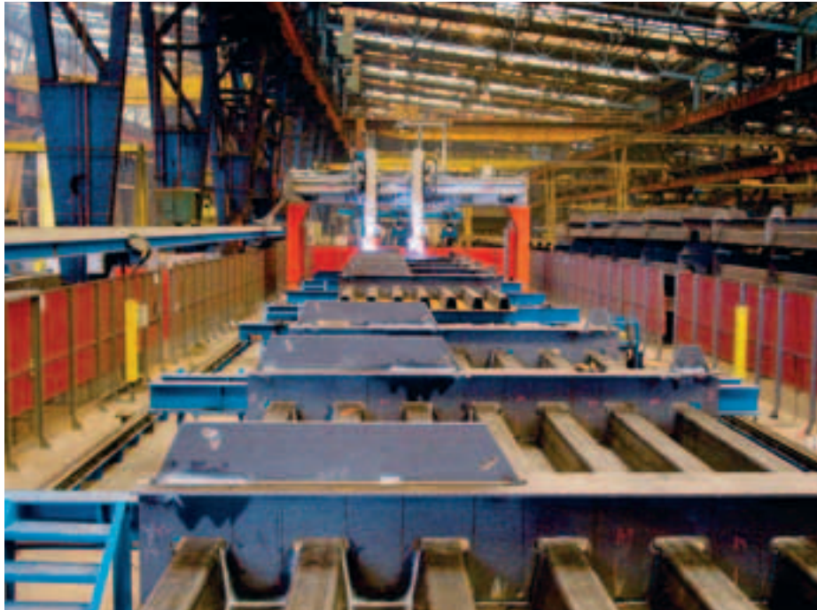
Photo 9 Fabrication du tablier dans l'usine de Lauterbourg Deck manufacture in the Lauterbourg factory
