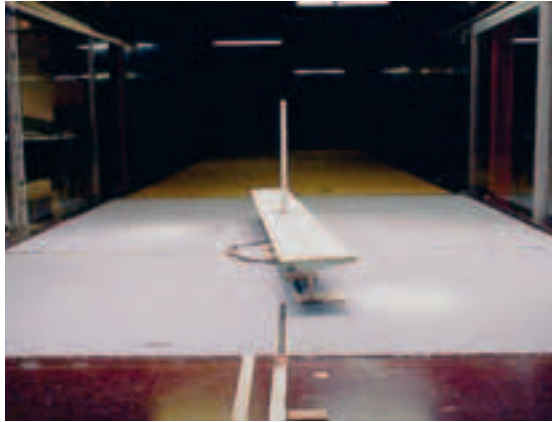
Photos 5 et 6 Maquettes spécifiques pour l'étude des effets du vent sur le pylône (à gauche) ou sur les palées métalliques provisoires (à droite)
