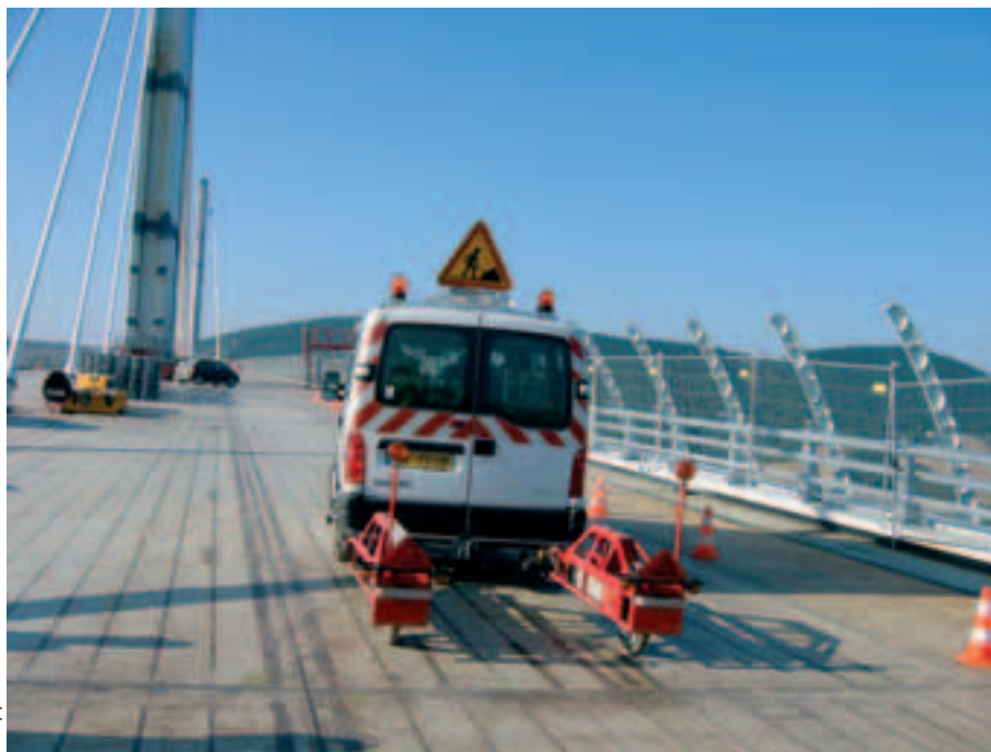
Photo 2 Mesure APL sur le tablier APL measurement on the deck
