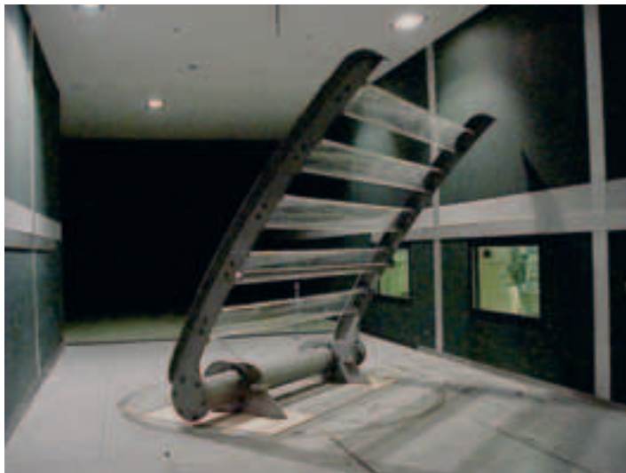
Photos 7 et 8 Prototype grandeur nature du brise-vent du viaduc de Millau utilisé pour la mesure du bruit
