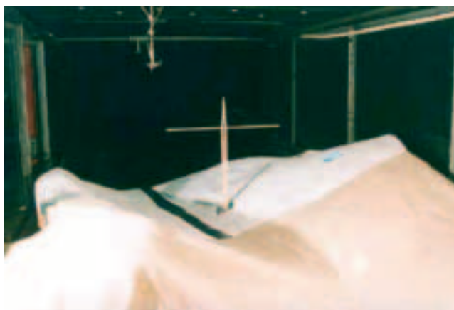
Photos 2 et 3 Deux maquettes du viaduc de Millau en soufflerie à couche limite atmosphérique, pour le projet béton (à gauche) puis pour le projet final (à droite) en phase de construction
