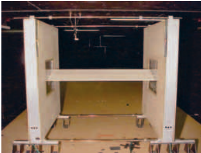
Photo 1 Essai sur un tronçon de tablier du viaduc de Millau dans la veine de la soufflerie atmosphérique du CSTB Testing on a deck section of Millau Viaduct in the airstream of the CSTB's atmospheric wind tunnel
