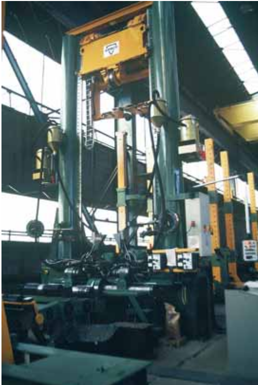
Photo 9 Vue d'ensemble de la machine à reconstituer les PRS General view of the welded-plate-girder welding machine
