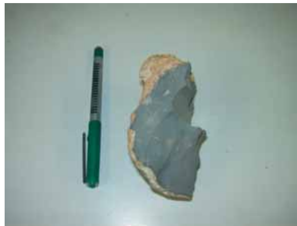
Photo 6 La rupture du scellement du tirant d'essai s'est effectuée dans le terrain, 1,5 à 2 cm de l'interface coulis/sol
