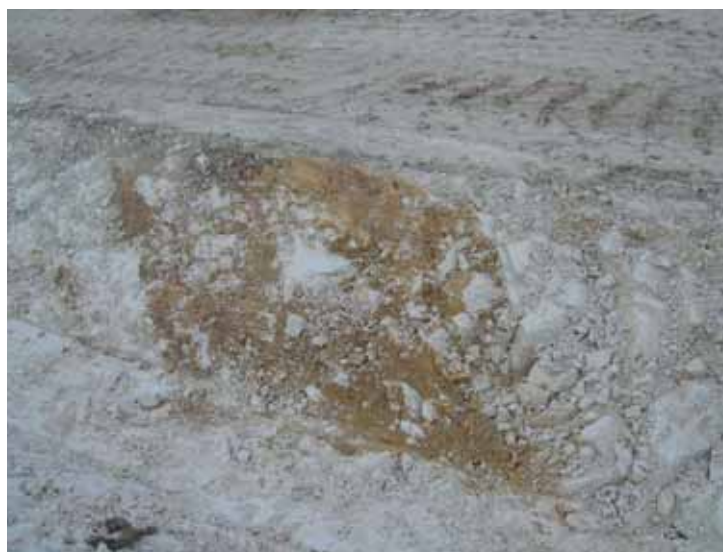
Photo 5 Remplissage sableux associé à un couloir de fracturation au sein de la craie massive du Sénonien Sandy filling together with a fracture corridor within the massive chalk of the Senonian
