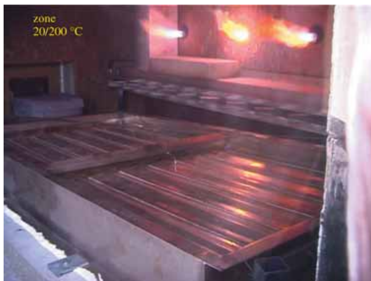
Essais en température des trappes de désenfumage
