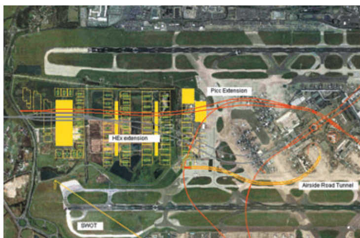
Photo 2 Visualisation des tracés en plan des différents tunnels sur une photo aérienne de l'aéroport
