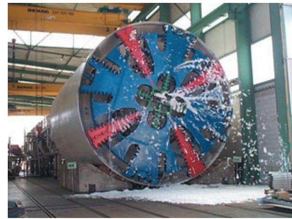
Photo 8 Tête de coupe du tunnelier TBM cutting head
