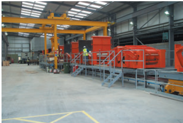
Photos 17 et 18 Moules utilisés pour les voussoirs ART, coulés "face en bas"
