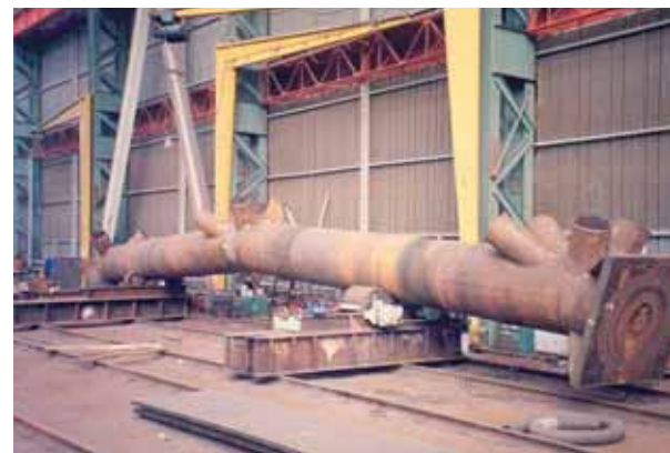
Figure 11 Membrure inférieure avec amorces des bracons Lower member with bracket starting points
