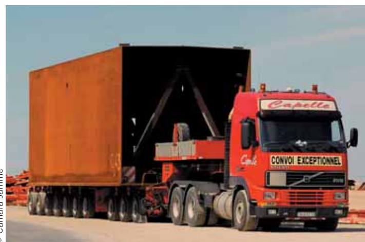
Photo 7 Transport des caissons centraux
