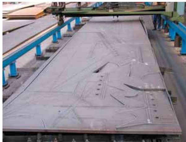
Figure 6 Découpage des tôles de goussets Cutting out of gusset plates
