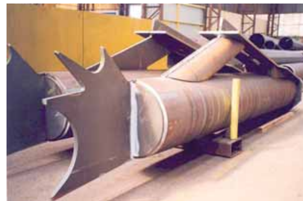
Figure 9 Elément M3/B5/P3 assemblé à blanc Element M3/B5/P3 trial-assembled
