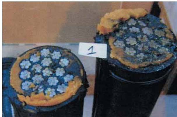
Photo 6 Essais d'injection à la cire des tubes PEHD fendus et ressoudés Wax injection tests on split and re-welded HD polyethylene tubes
