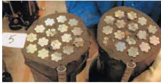
Photos 7 et 8 Essais d'injection à la cire des thermorétractables Wax injection tests on heat-shrinkable elements
