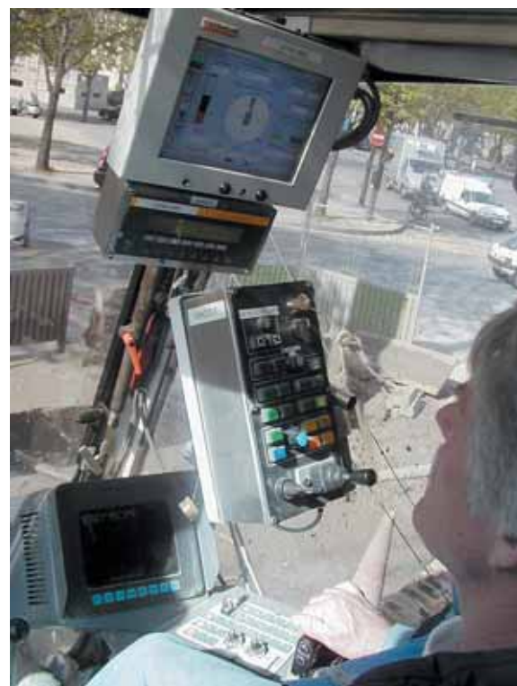
Le contrôle de positionnement de la benne par le machiniste
