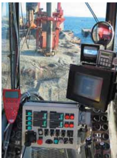
Contrôle de l'exécution, par enregistrement de paramètres et télésurveillance Control of construction, by recording of parameters and remote monitoring
