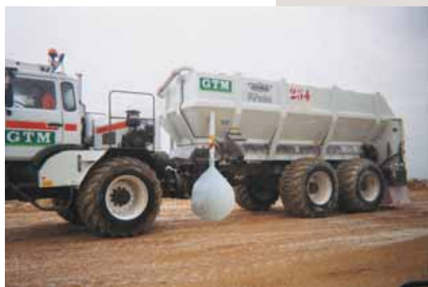
Photo 10 Ballon de filtration des événements d'épandeurs à chaux (A66 T1) Filtration flask for lime spreader vents (A66 T1)
