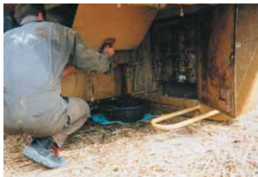
Photo 7 Mise en œuvre du kit antipollution sous une décapeuse retournée (A66 T1) Application of the pollution control kit under an overturned scraper (A66 T1)
