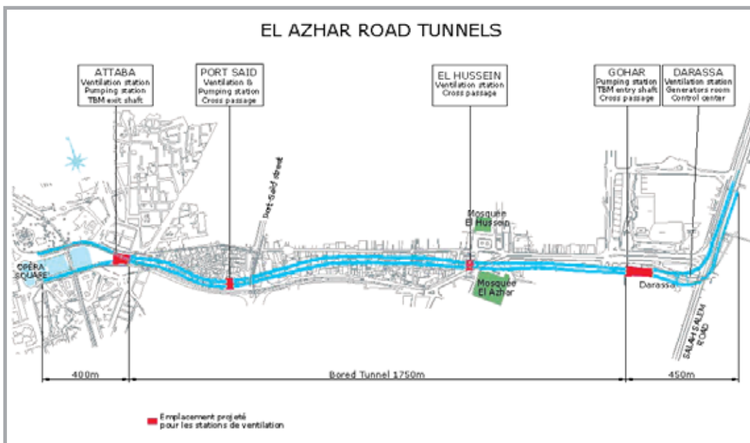
Figure 3 Plan du tracé avec stations de ventilation dédoublées Layout plan with doubled ventilation stations
