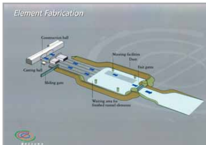
Figure 2 Tunnel de l'Øresund. Vue schématique des travaux à terre
