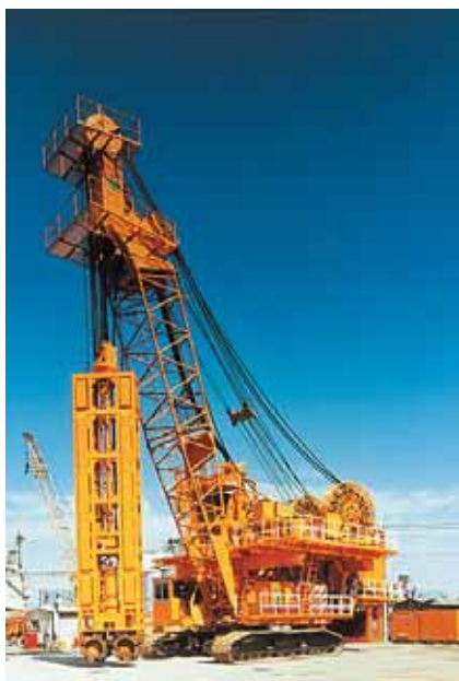
Photo 9 Nagoya Japon. Réservoir enterré pour stockage de gaz naturel liquéfié. Construction d'une paroi circulaire à 100 m de profondeur utilisant une hydrofraise de 245 t
