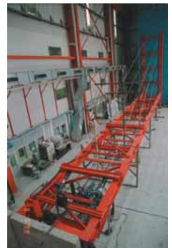
Photo 13 Projet ACE. Le modèle réduit de pont à haubans avec ses haubans actifs lors des essais
