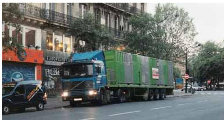
**Poste mobile d'injection : une centrale d'injection autonome posée sur la remorque d'un camion, rapide à déplacer et à installer; un impact sonore limité, l'ensemble du matériel étant monté à l'intérieur d'un container insonorisé**
