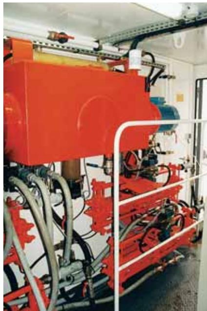
Poste mobile d'injection - Les presses d'injection sont fixées à la paroi du container pour ne prendre qu'une emprise minimum
