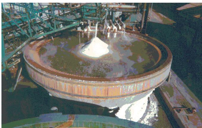
**Saturateur à sel. Vue générale après mise en sécurité. On distingue le ceinturage par lattes de bois et bandes de T.F.C.**
