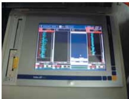
**Ecran de contrôle et de pilotage de l'injection dans un poste mobile. Visualisation des courbes de débit et de pression instantanée pour les forages d'injection**
