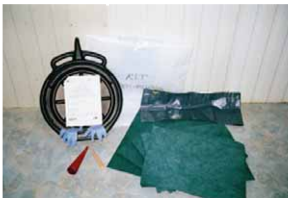
Photo 2 Kit de dépollution présent dans les véhicules des gens de chantier afin de pallier une pollution accidentelle par hydrocarbure sur le chantier
