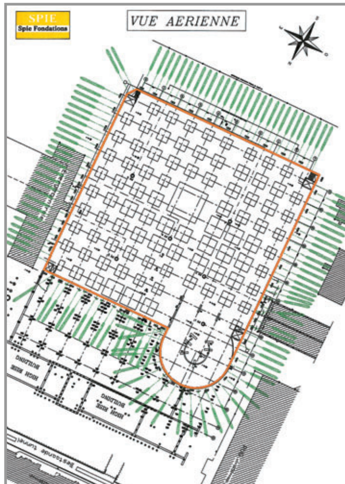
Figure 3 Vue en plan de la paroi moulée Plan view of diaphragm wall
