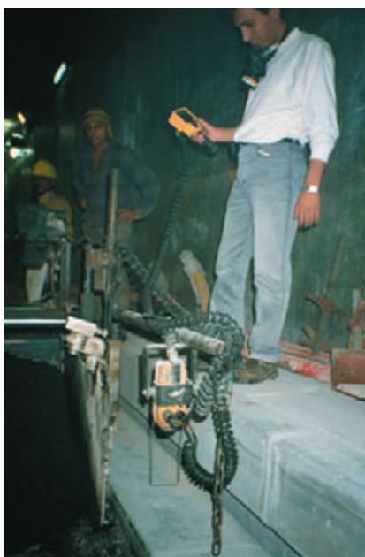
Photo 10 Position du palpeur à ultrason dans le caniveau Position of ultrasonic sensor in the gutter
