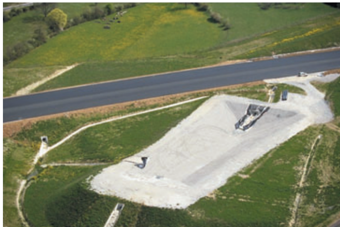
Vue aérienne bassin et réseau de cunettes Aerial view of reservoir and network of gutters
