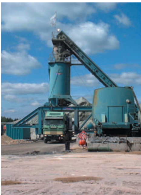
Centrale de fabrication des enrobés TSM 25 de 450 t/h Asphalt mixing plant TSM 25, capacity 450 tonnes/h
