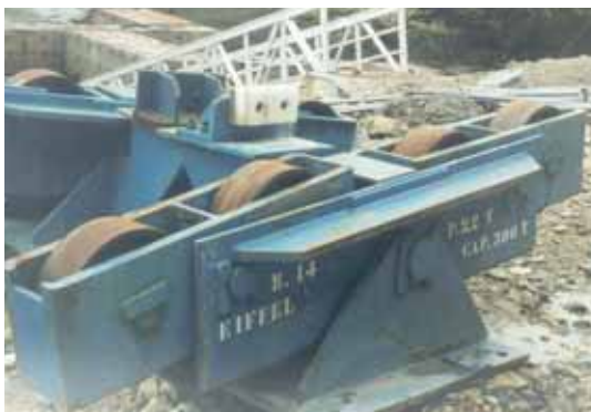
Photo 11 Une chaise à galets de lancement du tablier V2 A rocking roller for launching of deck V2
