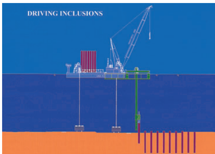
Figure 4 Battage des inclusions. La barge à pieds tendus Lisa et le catamaran en phase de battage des inclusions
