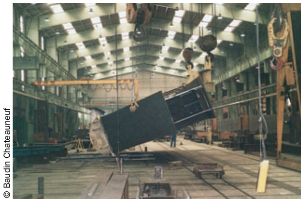
Photo 4 Retournement d'un chevêtre à l'aide de ponts roulants Turning over a header with overhead travelling cranes
