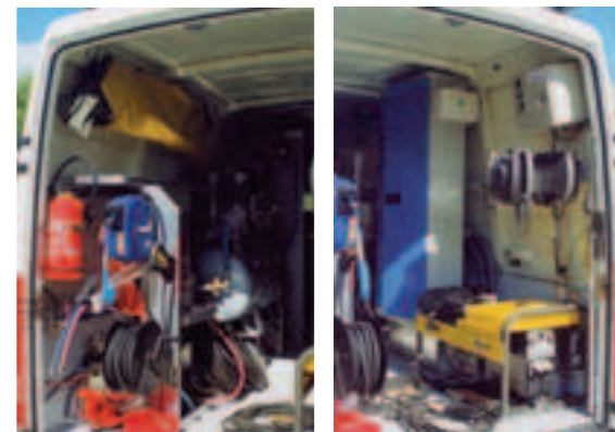
Photos 3 et 4 Equipements des parties gauche et droite du fourgon Equipment of left and right parts of van
