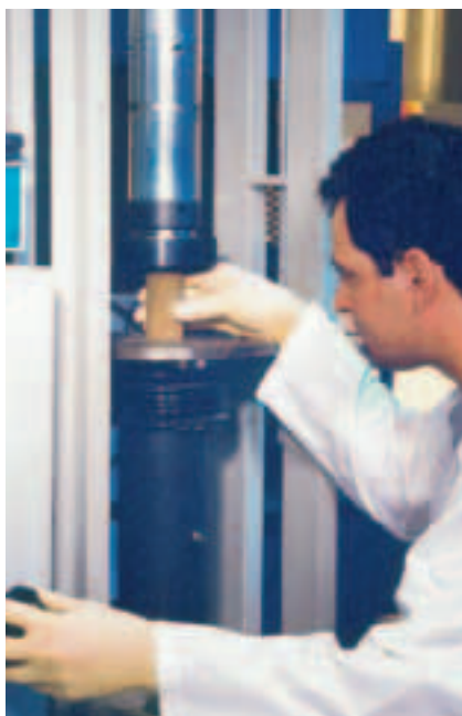
Photo 13 Test de résistance à la compression (Inertec) Compressive strength test (Inertec)
