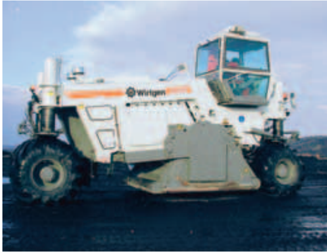
Essai de traitement au malaxeur Wirtgen WR2500
