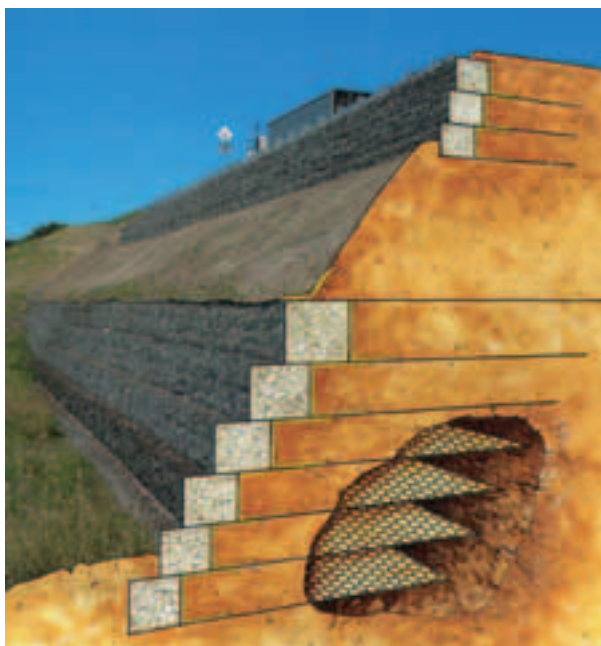
Principe de mise œuvre du Terramesh® System
