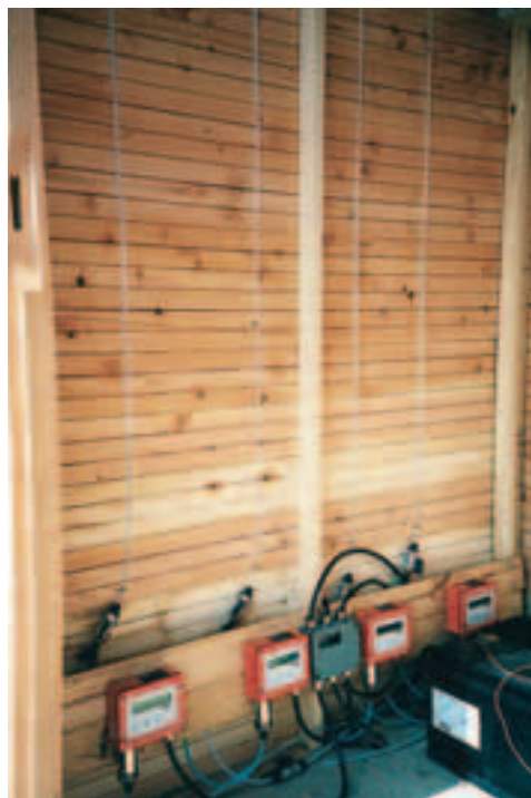
Photo 3 Système de mesures à l'intérieur des cabines
