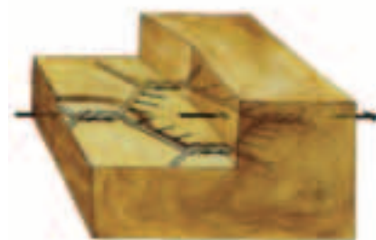
Structure réalisée en grillage double torsion à maille hexagonale
