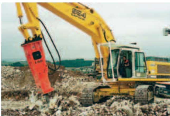
Brise-roche NPK Heavy duty monté sur Litronic 954
