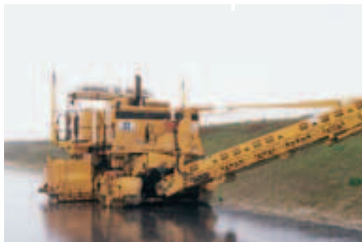
Photo 2 Autograde CMI pour découpe de la couche de STLH
