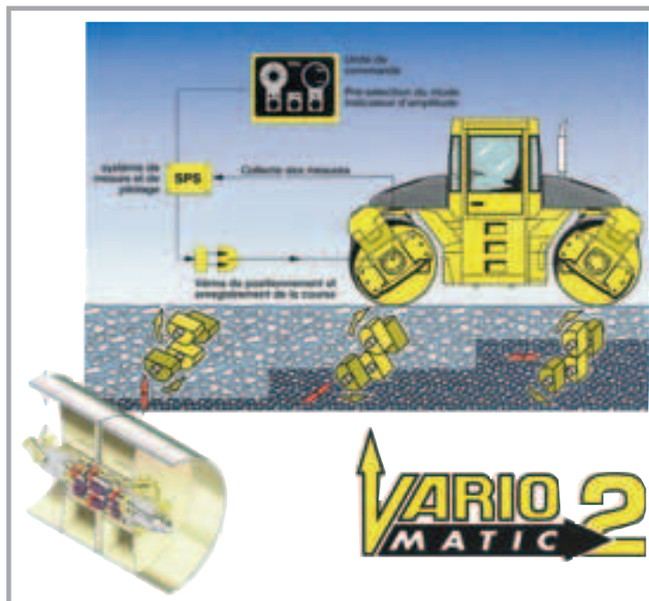
Schéma de fonctionnement du Variomatic 2 Bomag
