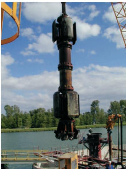
**Vue des outils de forage : trépan à molettes. A remarquer les dispositifs de centrage de l'outil en partie inférieure et supérieure du corps**
