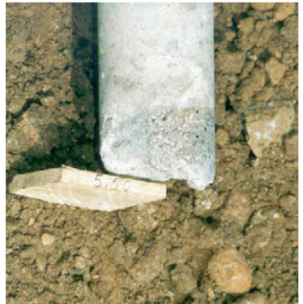
Cette diagraphie est caractéristique d'un défaut de continuité du bétonnage concrétisé par la photographie (figures 4 et 5) des carottes de matériaux prélevés.
