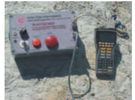
Boîtier de tir et terminal de supervision. Avant toute opération de mise à feu, le terminal de supervision diagnostique toutes les erreurs éventuelles
