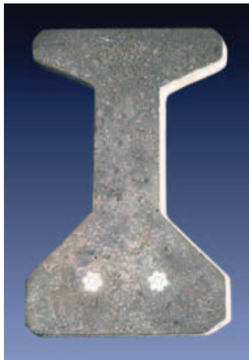
Coupe d'une poutrelle en BSI montrant la structure fibrée
