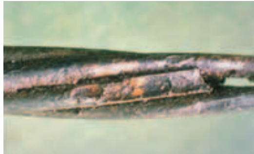
Photo 1 Soundprint® filtre les bruits captés et identifie par exemple l'onde correspondant à la rupture d'un fil d'acier dans un toron
