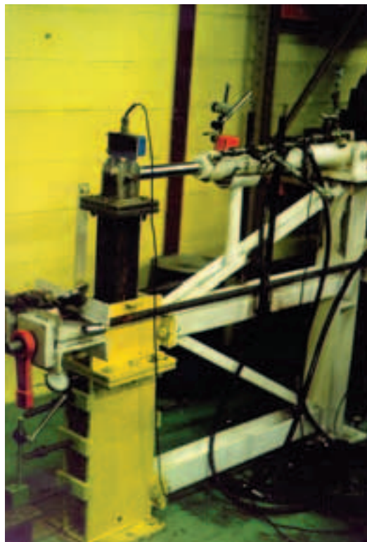
Photo 4 Vue d'un barreau amortisseur en cours de test sous chargement cyclique
