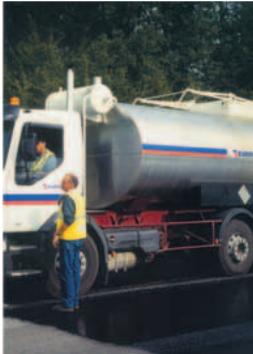
Photo 2 Emulvia P pour couche d'accrochage "propre" Emulvia P for "clean" tack coats
