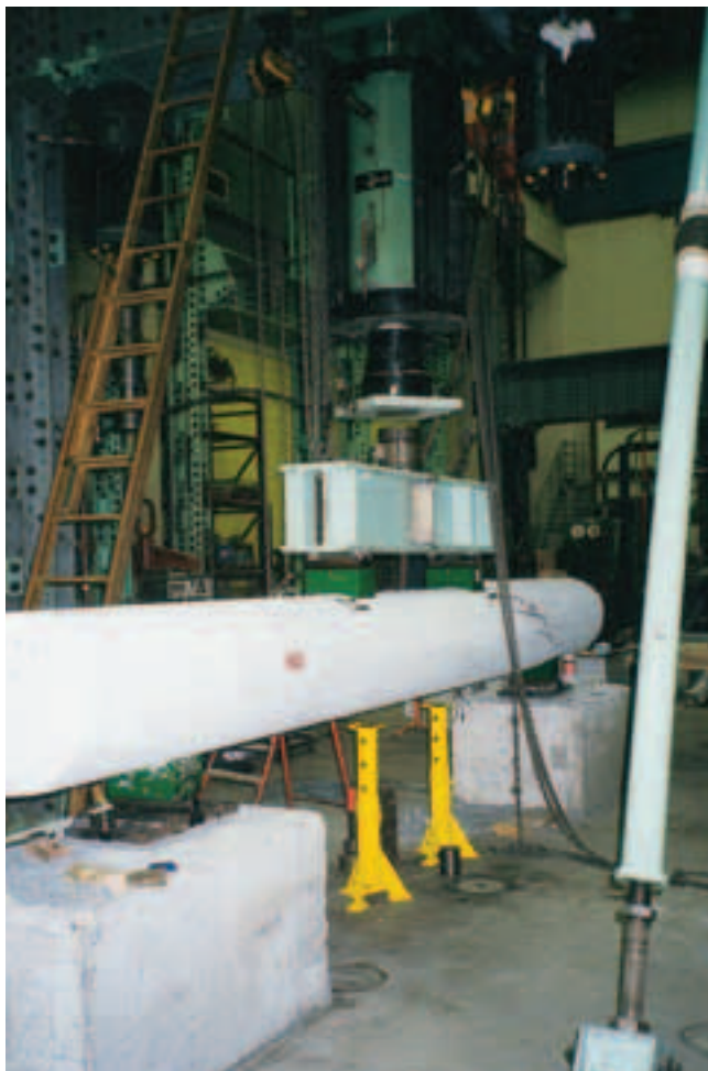
Projet national BEFIM. Essai de pieux en béton de fibres métalliques
