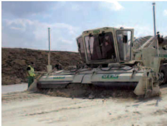
Photo 4 CENTAUR nivelle au centimètre CENTAUR, levelling to within a centimetre
