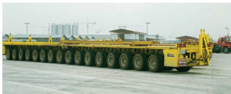
Figure 19 16-axles trailer for D6 pier segments Remorques 16 ponts pour VSP D6
