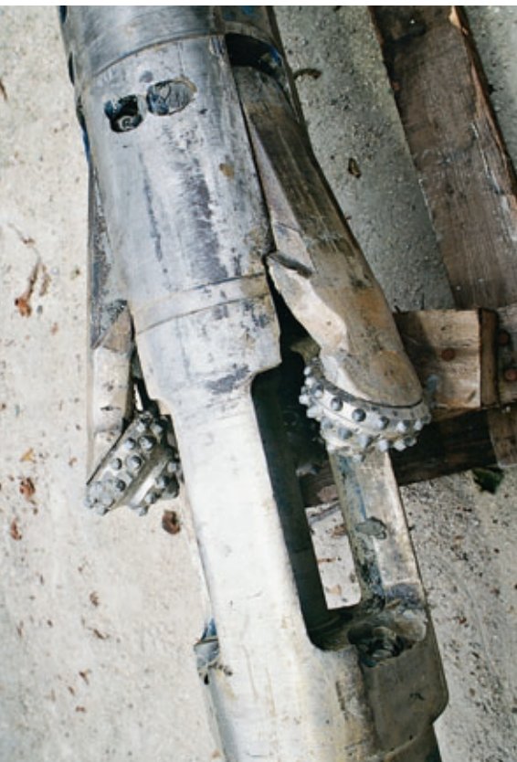
Photo 3 Aléreur de l'aquifère Aquifer reamer
