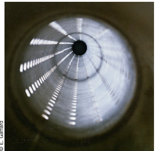
Photo 4 Introduction de la crépine inox (espace entre fils 1 mm) Introducing the stainless steel strainer (1 mm mesh)
