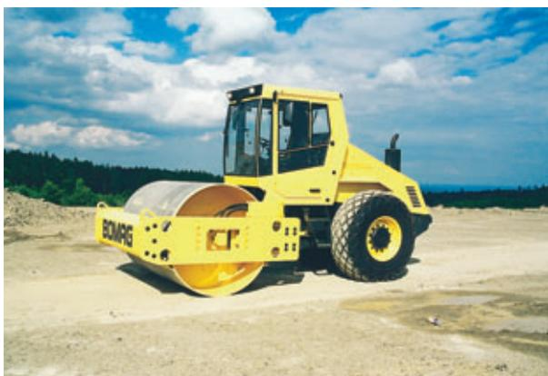
**Bomag. Compacteur BW 211 D3 avec cylindre lisse**
