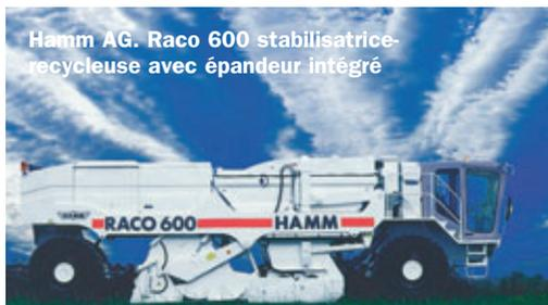
Hamm AG. Raco 600 stabilisatrice-recycleuse avec épandeur intégré
