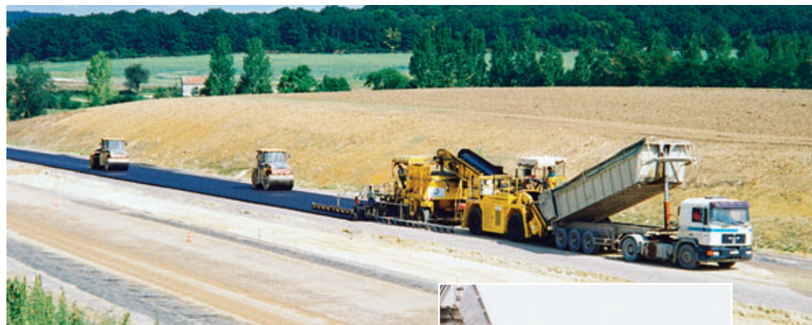
Photo 3 Vue d'ensemble de l'atelier de mise en œuvre (finisseur Vogele S 2500 et alimentateur Franex)
