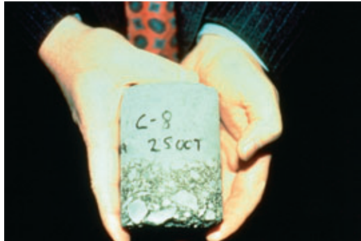
Photo 2 Carotte prélevée dans une structure composite après plusieurs années de service prouve que le collage est durable
