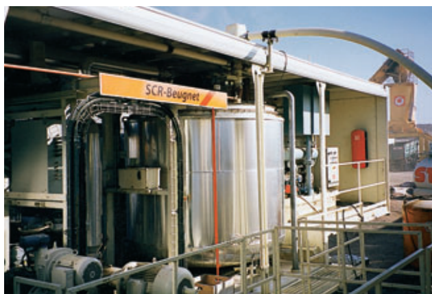
Unité de liant modifié et centrale Ermont TSM 25 Ermont TSM 25 plant and modified binder unit
