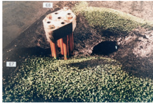
Photo 4 Etudes hydrauliques sur modèle réduit physique des appuis dans le fleuve. Vue de l'état des fonds au voisinage de la pile P1 après simulation de la crue centennale (essai sans protection)
