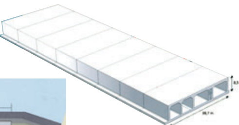
Vue schématique d'un élément composé de huit segments de 22 m de long Schematic view of an element composed of eight segments 22 m long
