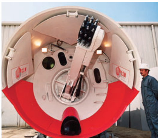
Tunnelier pressurisable à attaque ponctuelle Pressurisable point-attack TBM
