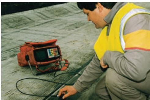
Contrôle des soudures par auscultation aux ultrasons
