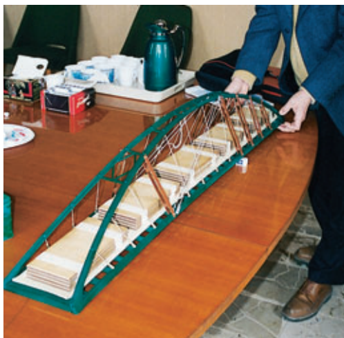
Photo 6 Maquette de l'ouvrage ayant facilité la mise au point du montage
