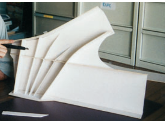
Photo 4 Maquette du nœud d'about ayant permis sa conception Model of end node used for its design
