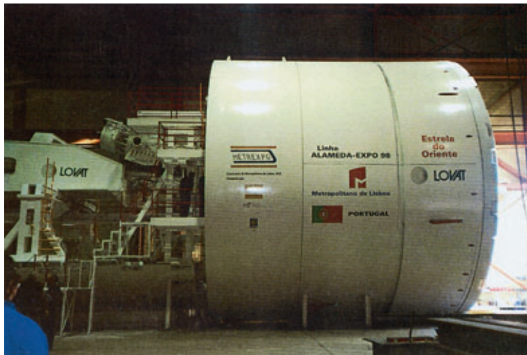
Photo 4 Tunnelier à pression de terre Lovat Lovat EPB - TBM
