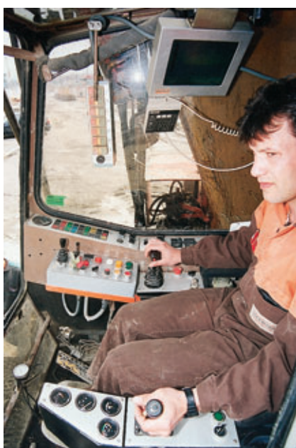
Photo 3 La géométrie du site a imposé pour la perforation de la paroi, implantée à proximité immédiate des mitoyens, l'utilisation de l'outillage KS 3000 et de son automatisme associé Sakso (système d'excavation assisté par ordinateur)
