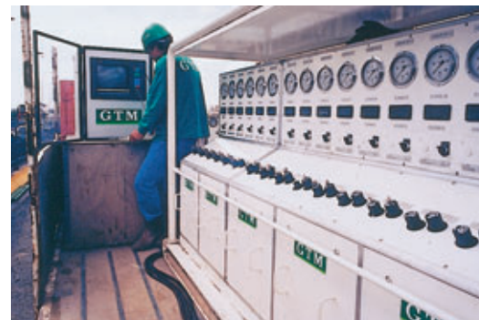
Photo 3 Vérinage assisté par ordinateur. Pupitre et ordinateur Computer-assisted jacking. Console and computer
