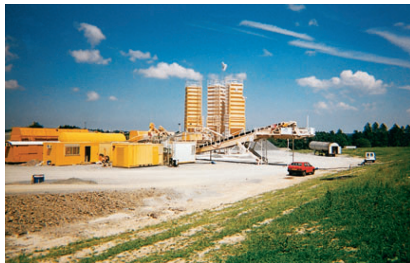
Photo 1 Centrale mobile de malaxage SAE Sam 804 BI (800 t/h)
