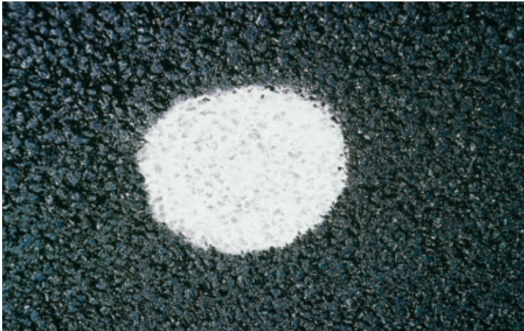
Photo 5 Vérification de la macrotexture du Tapiflex par essai de hauteur au sable Checking the macrotexture of Tapiflex by the sand patch test
