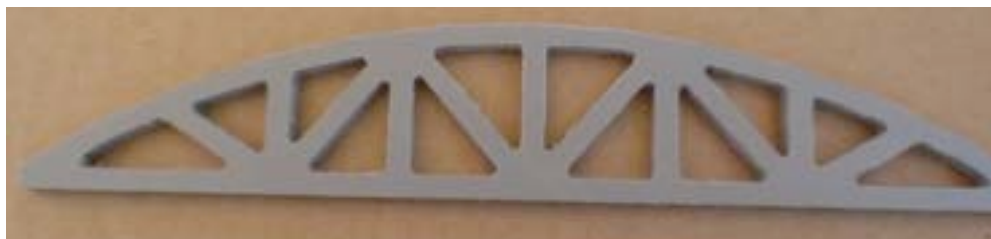
Réalisation en commande numérique (fraiseuse CN)
