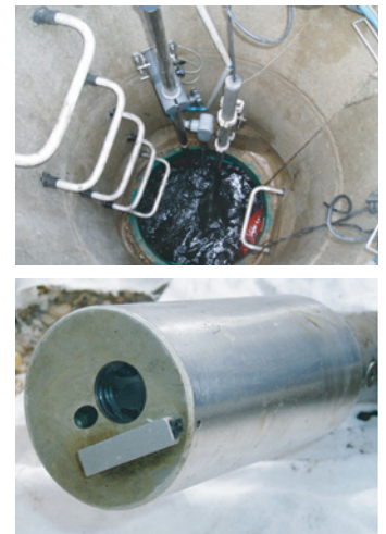
Figure 19. Installation du parc de Sceaux : la chambre d'accès (en haut), le capteur (en bas) et la disposition du site (à gauche)
