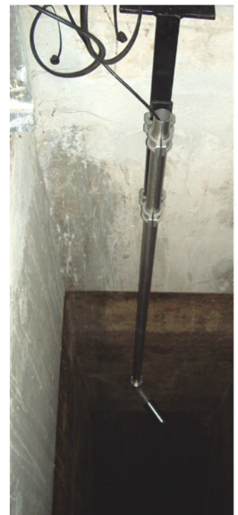
Figure 17. Installation du bassin Keller : montage sur perche rigide (à droite), disposition des instruments sur le site (à gauche).
