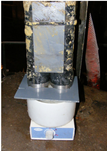
Figure 14. Vérification in situ réalisée dans un seau opaque équipé d'un couvercle et d'un agitateur (source : IFSTTAR).
