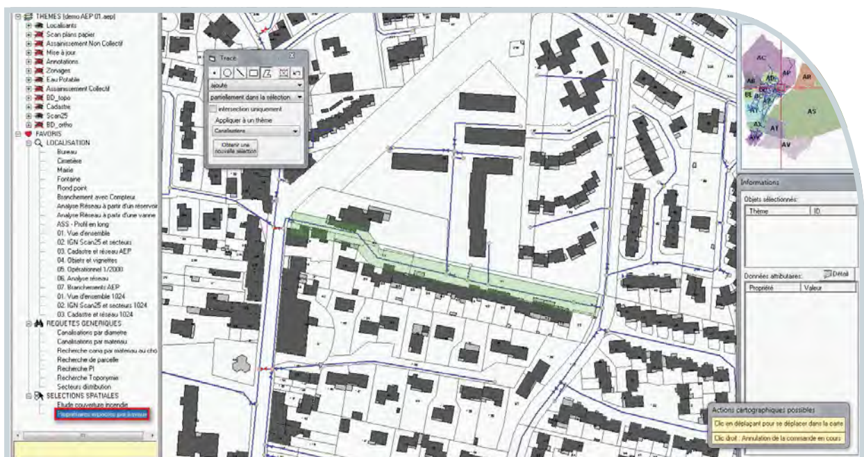
Figure 55 Sélection spatiale de la zone de travaux
